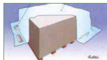
Nên cất giữ ở những nơi bằng phẳng, khô ráo và không có ánh nắng và để trên 4 miếng gỗ. Một chồng không được chất hơn 40 tấm
