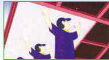
Nên đưa tấm lên hệ khung làm trần bởi 3 người giữ cân ở vị trí đầu - giữa - cuối của tấm
