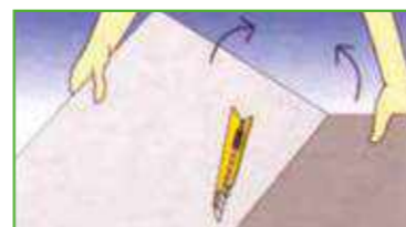
Tấm có thể được cắt bằng dao. Nhấn mạnh dao chừng 1/3 độ dày theo những hướng cần thiết, sau đó bẻ gấp lên, dùng giấy nhám chà nhẵn các đường cắt
