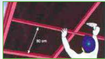
Khoảng cách giữa các thanh trên khung chính không vượt quá 80cm. Khung có thể bằng gỗ, kim loại hoặc thanh đá chữ C
