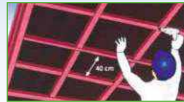
Cài đặt thanh phụ với khoảng cách thanh phụ không quá 4cm
