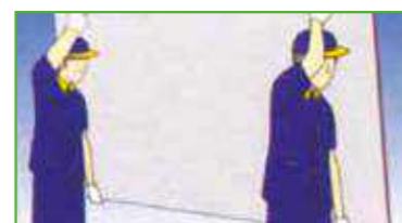
Khi khiêng tấm, hai người khiêng ở hai vị trí đầu tấm & vác tấm theo chiều dọc
